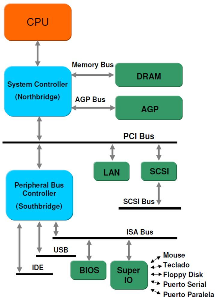
A partir del año 2000, Intel introduce cambios y deja de utilizar el PCI como “bus central” del sistema, buscando lograr mejores velocidades de transferencia entre los distintos componentes. De allí que reemplaza la terminología “northbridge” y “southbridge” por la de “hubs”: MCH (Memory Controller Hub = Northbridge) y ICH (IO Controller Hub = Southbridge).
