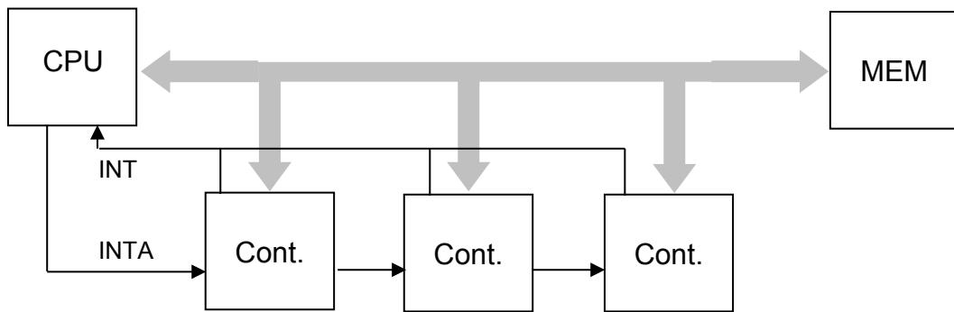
De esta manera cuando la CPU inicia el ciclo de atención a un pedido de interrupción y levanta su señal de salida INTA, la misma se va propagando por los distintos controladores en forma encadenada. De esta forma el primer controlador de la cadena que tenga un pedido de interrupción pendiente procederá a no continuar con la propagación de la señal INTA hacia los restantes controladores y será él quien coloque en el bus de datos su identificador.
