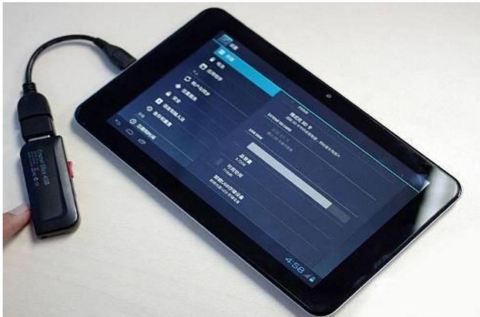
Figura 10: Pendrive conectado a una Tablet mediante un cable USB OTG.
