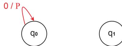
$$\delta(q_0, 0) = q_0 \text{ y } \lambda(q_0) = P \\ \Rightarrow \delta'(q_0, 0) = q_0 \text{ y } \lambda'(q_0, 0) = P$$
